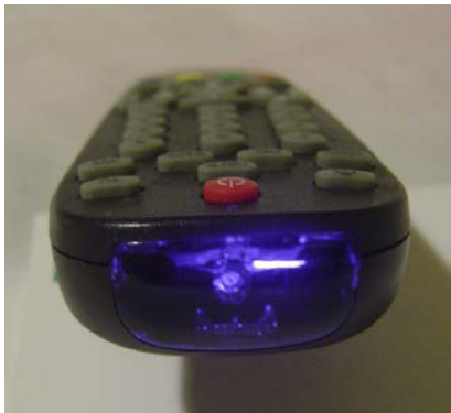
Telecomando inattivo osservato con una telecamera digitale che emette e rileva radiazione nell'infrarosso vicino.
