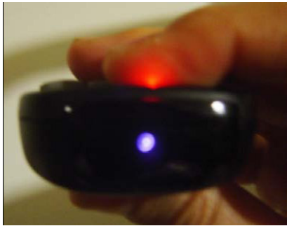
Gli allievi possono osservare che la copertura del telecomando è opaca alla luce visibile ma è trasparente all'infrarosso vicino.
