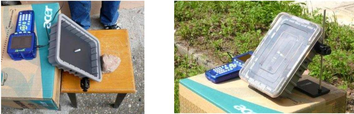
Fig. 1- Misura della temperatura di equilibrio della piastra nera senza e con il coperchio di plastica.
