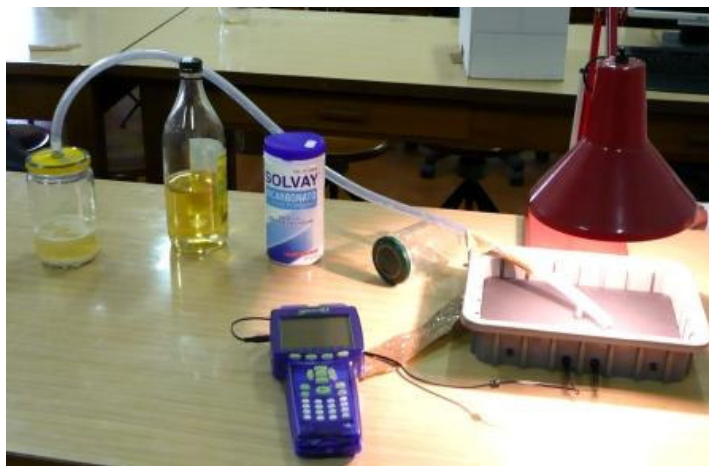
Fig. 12. Un semplice esperimento per evidenziare il ruolo della \text{CO}_2 nell'effetto serra
