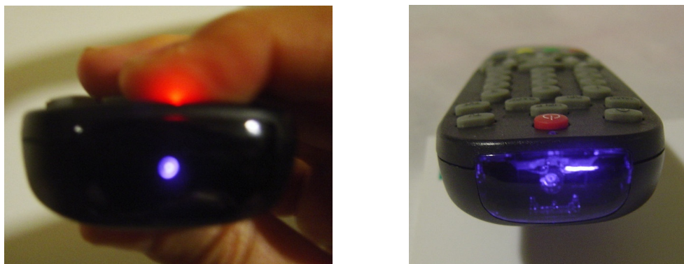
Fig. 5. Fotografare la radiazione infrarossa emessa da un telecomando
