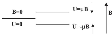
Fig. 5. – Livelli energetici del momento magnetico  $\mu$ , con e senza campo magnetico, secondo l'ipotesi quantica.
