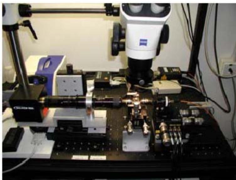
Figura 12 Apparato di misura per guide d'onda fotoniche.
