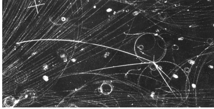
Figura 5.6: Fotodisintegrazione del nucleo di Ar in camera a diffusione (argon a 1 atm in campo magnetico di 18000 G) esposta al fascio fortemente ridotto di \gamma dell'elettrosincrotrone di Frascati.
