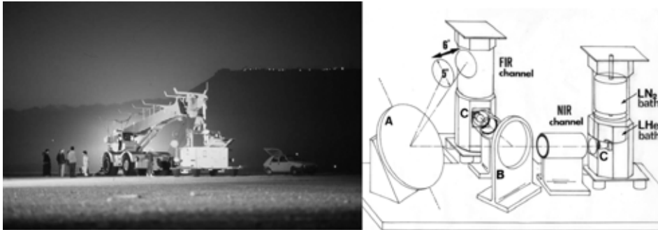
Figura 20.1: Lancio dell'esperimento ULISSE da Trapani, nel 1980 e schema dello strumento.
