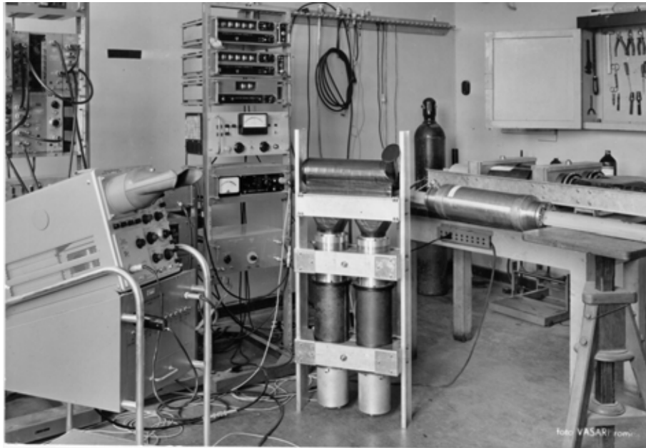
Figura 14.3: Vista del contatore a toluolo durante i test in laboratorio.
