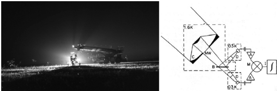
Figura 20.2: L'esperimento di misura delle fluttuazioni quantistiche del fondo a microonde: secondo lancio dell'esperimento da Trapani, nel 1984. A destra: schema dello strumento.
