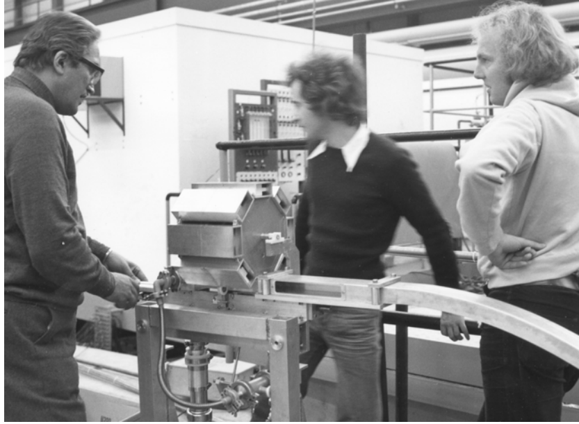
Figura 9.2: Esperimento WA-58. Contenitore per l'inserimento delle emulsioni nucleari (circa ogni 20 secondi) e guida di scorrimento.
