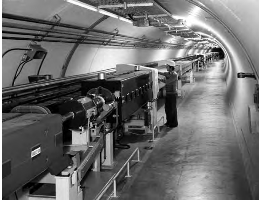
Figura 8.19: Tunnel del Super ProtoSincrotrone. In primo piano uno degli 800 magneti bipolari (ciascuno lungo 6 m) per la guida del fascio. (Archivio CERN).
