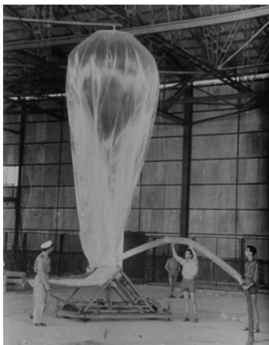
Figura 19.1: Lancio di palloni atmosferici dalla Sardegna per lo studio della produzione di particelle strane (Aeroporto di Cagliari-Elmas, 1953). Gli stack di emulsioni nucleari viaggiavano agganciati ai palloni fino ad alta quota e venivano recuperati immediatamente dopo l'ammarraggio (Archivio Dipartimento di Fisica Università La Sapienza, Roma).
