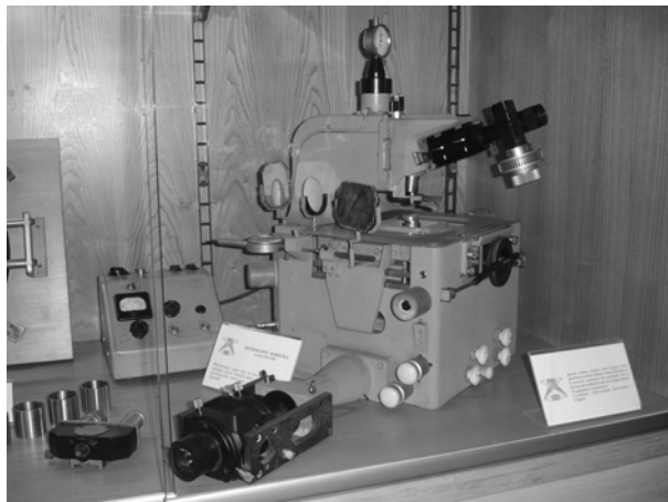
Figura 19.3: Microscopio Koritska MS2, utilizzato a Roma per oltre trenta anni per misure di altissima precisione (1956).
