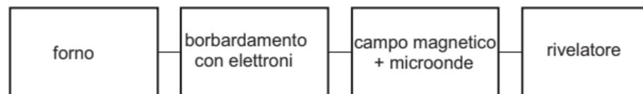
Schema dell'apparato sperimentale. Il campo magnetico suddivide i livelli energetici per effetto Zeeman. In assenza di campo magnetico, anche un piccolo campo elettrico potrebbe mescolare i due stati  $2^2s_{1/2}$  e  $2^2p_{1/2}$  riducendo la metastabilità dello stato  $2^2s_{1/2}$  [Caldirola, 1950, pp. 97-98]
